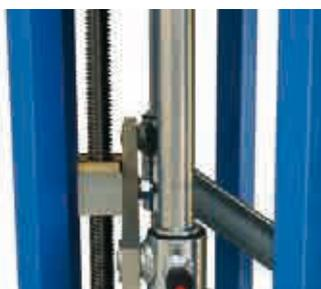
Si può azionare la macchina utilizzando un avvitatore o semplicemente utilizzando una chiave da 19 mm
